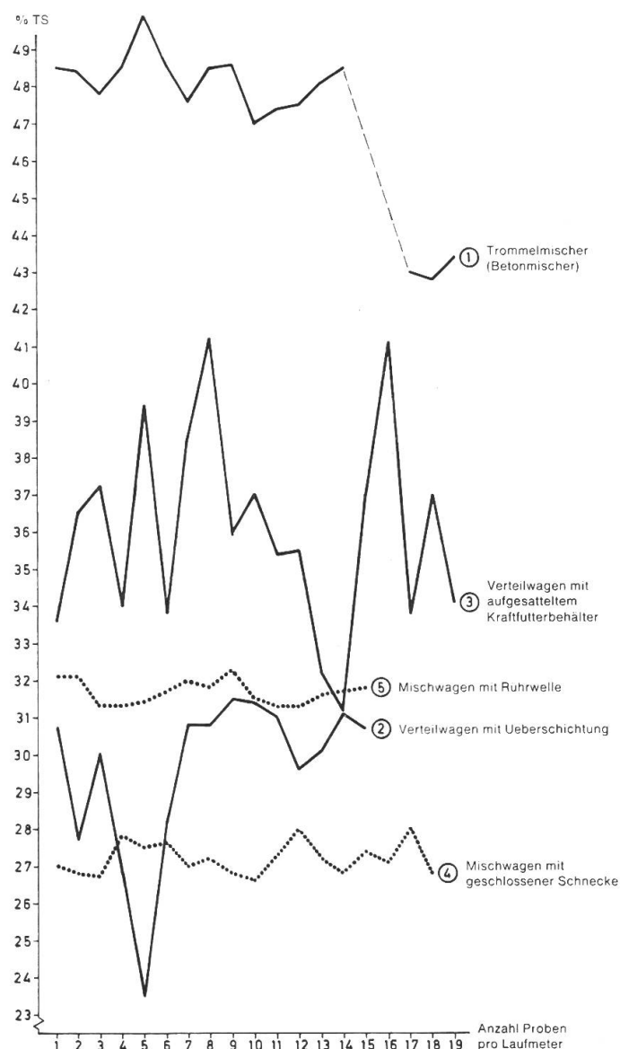
Abb. 1: Mischgenauigkeit bei verschiedenen Futterverteil- und Mischwagen (nach Pirkelmann).
