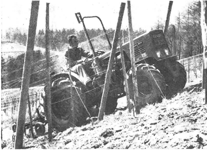
Abb. 4: Fendt-Spezialtraktor für Wein- und Hopfenbau. Kompakte, sehr schmale und besonders niedrige Bauweise mit tiefer Schwerpunktlage, Mittelenkung und moderner Fahrkomfort sind die Vorzüge der neuen Weinbau-Traktoren 200 V (38 PS / 27,5 kW) und Farmer 203 V (50 PS / 37 kW).
