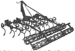
In Breiten von 2 m — 3,3 m (auch Block-Chassis), kombinierbar mit Tiefgrubber, Doppelzinken.
