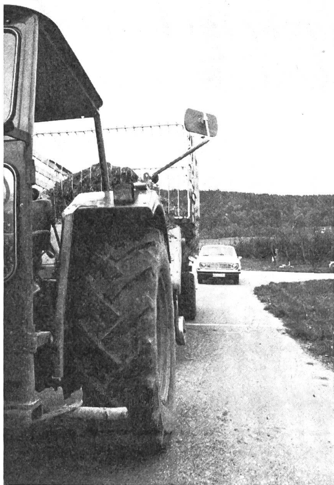
Abb. 1: Der massive, ausziehbare Rückspiegel an einem Traktor mit Sicherheitskabine. Es gibt verschiedene Befestigungsmöglichkeiten, so dass der Spiegel praktisch an allen Traktoren angebracht werden kann. Bei Nichtgebrauch und bei Hindernissen wird die Einrichtung zurückgeschwenkt.
