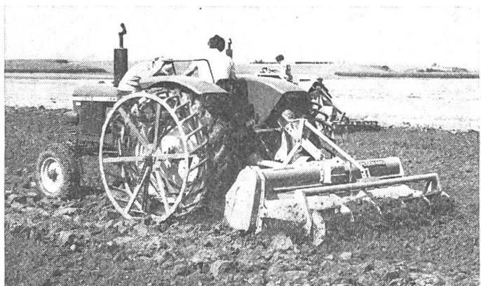
den Acker in einem einzigen Arbeitsgang für die neue Saat vorzubereiten. Hiezu eignet sich eine neue Kombination von Tiefgrubber und Kreiselegge, die den Boden bis in eine Tiefe von 30–40 cm auflockert und gleichzeitig an der Oberfläche zur Saat vorbereitet. Dieses Gerät setzt Traktoren mit einer Zugkraft von 45–52 kW voraus.
