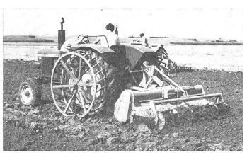
den Acker in einem einzigen Arbeitsgang für die neue Saat vorzubereiten. Hiezu eignet sich eine neue Kombination von Tiefgrubber und Kreiselegge, die den Boden bis in eine Tiefe von 30–40 cm auflockert und gleichzeitig an der Oberfläche zur Saat vorbereitet. Dieses Gerät setzt Traktoren mit einer Zugkraft von 45–52 kW voraus.
