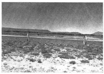
hundert Metern zusammengekoppelt sind. Sie bilden die Mittelachse von Rädern aus gleichem Metall, die einen Durchmesser von ungefähr 1,5 m haben und in Abständen von schätzungsweise 5 m voneinander angebracht sind. An einer Stelle befindet sich ein weisses Gehäuse in grossem Abstand zu weiteren, die offenbar die Steuerorgane enthalten.
