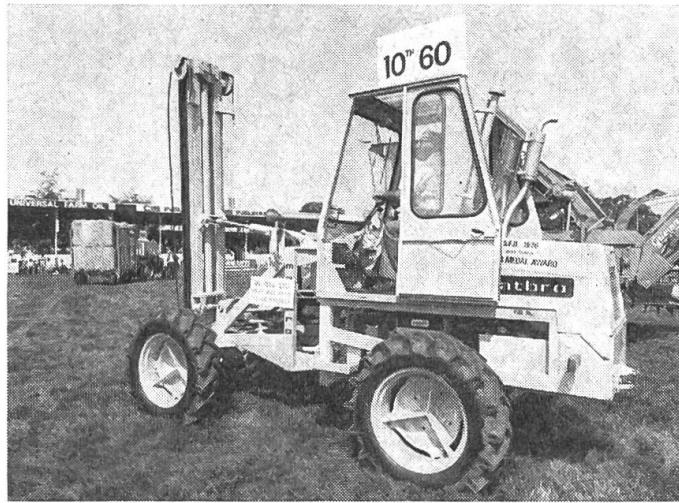
Dieser Gabelstapler, angetrieben durch ein Motorfahrzeug mit Vierradantrieb, ermöglicht ausgezeichnete Hebe- und Zugleistungen. Das Gewicht der Maschine wurde so gehalten, dass Stabilität und Sicherheit darunter nicht leiden. Motor, Hydraulikanlage und Treibstoffbehälter sind ganz hinten angeordnet, weshalb sich das Anbringen lästiger Gegengewichte erübrigert. Ein seitlich schrägstellbares Hubgerüst garantiert ein sicheres Senkrechtheben der Last.
