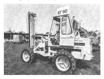
Dieser Gabelstapler, angetrieben durch ein Motorfahrzeug mit Vierradantrieb, ermöglicht ausgezeichnete Hebe- und Zugleistungen. Das Gewicht der Maschine wurde so gehalten, dass Stabilität und Sicherheit darunter nicht leiden. Motor, Hydraulikanlage und Treibstoffbehälter sind ganz hinten angeordnet, weshalb sich das Anbringen lästiger Gegengewichte erübrigt. Ein seitlich schrägstellbares Hubgerüst garantiert ein sicheres Senkrechtheben der Last.
