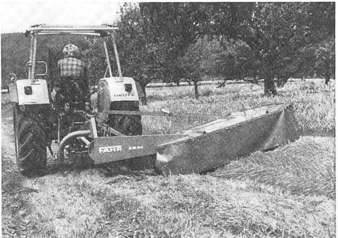
Der Kreiselmäher bringt seine volle Leistung auch beim Ausmähen von Böschungen und Gräben. Neigung  $\pm 20^\circ$  bewältigt er spielend. Selbst ein überschienenes Hindernis kann dem Kreiselmäher wenig anhaben. Eine Auffahrtsicherung erlaubt das Ausklinken und Zurückschwenken der Maschine.
