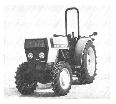
eine Motor- und Wegzapfwelle. Die Wegzapfwelle sorgt für noch mehr Einsatzmöglichkeiten bei Pflegearbeiten und mit Triebachsanhängern.
