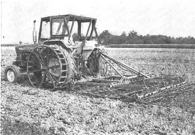
Abb. 2: Die Gitterräder bringen zwar eine höhere Zugkraft (nach eigenen Messungen ca. 2–4%), doch ist die Eindringtiefe in den Boden grösser. Ausserdem können sie erst am Acker montiert werden, so dass deren Transport dorthin einen zusätzlichen Aufwand bedeutet.
