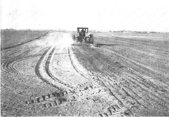
Abb. 1: Die Doppelbereifung wird sich besonders dort gut bewähren, wo die zu den Originalreifen dazugespannten schmalen aber gleich hohen Räder zugleich für das Reihenhacken verwendet werden können. Ausserdem kann mit der Doppelbereifung auch auf öffentlichen Strassen gefahren werden, wenn die gesetzlich erlaubte Gesamtbreite damit nicht überschritten wird.
