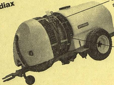
Die einzige Gebläse-spritze mit Frontgebläse. Da das Ansaugen der Luft von vorne erfolgt, ist ein Wiederansaugen des Spritznebels ausgeschlossen.
