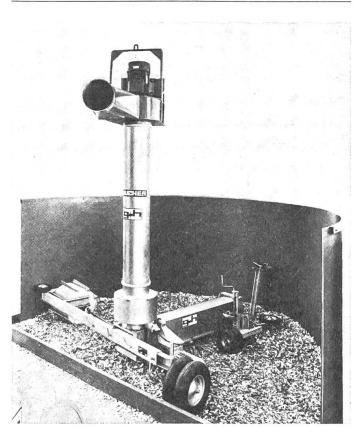
Abb. 3: Silofräse aus rostfreiem Edelstahl.
