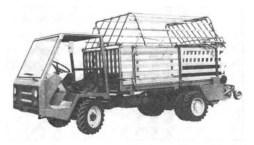
Abb. 2: Der neue BUCHER-Transporter wird in 3 verschiedenen Grössen hergestellt, mit sehr ruhig laufenden Motoren und auf Gummi gelagertem Fahrerstand. Die zwei grösseren Modelle besitzen ein Reversiergetriebe mit 8 Vor- und 8 Rückwärtsgängen.
