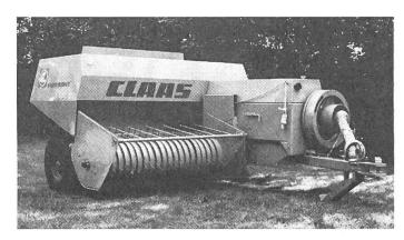
Abb. 6: Hochdruckpresse Claas Markant 55 mit 1,65 m breiter Pickup-Trommel und kettenlosem Zwangsantrieb für die synchron arbeitenden Organe.
