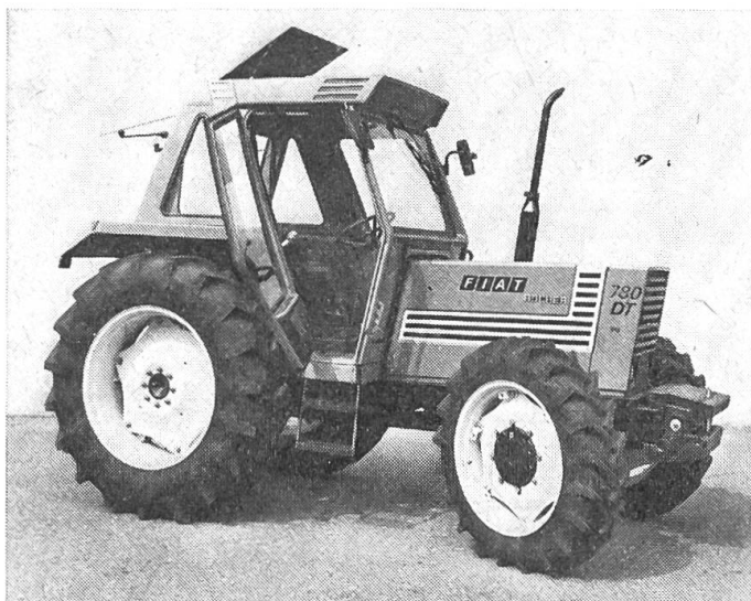
Abb. 1: FIAT-Traktor 780 mit Superkomfortkabine, erhältlich mit Zwei- und Vierradantrieb.
