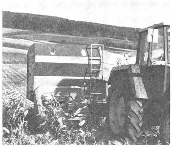
MEX SPEZIAL-II, Vollernter für Maiskolbenschrot, 2-reihig, 3-m³-Bunker, bis 6 t/h Korn-Spindel-Gemisch.
