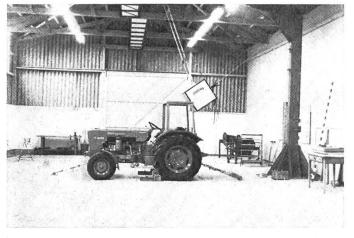
Abb. 4: Prüfstand für Fahrerschutzvorrichtungen in Tänikon.
