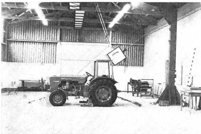
Abb. 4: Prüfstand für Fahrerschutzeinrichtungen in Tänikon.
