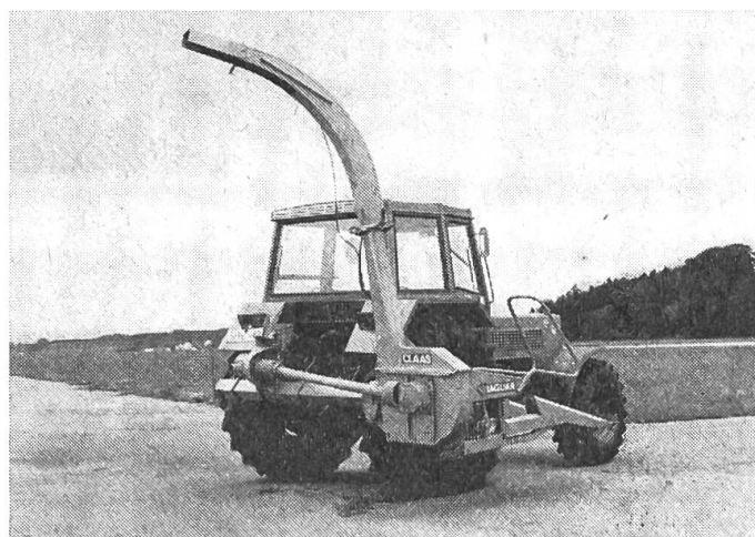
Abb. 1: Anbau-Maishäcksler Claas Jaguar 30 mit senkrecht stehenden Einzugsrollen und senkrechter Messertrommel.
