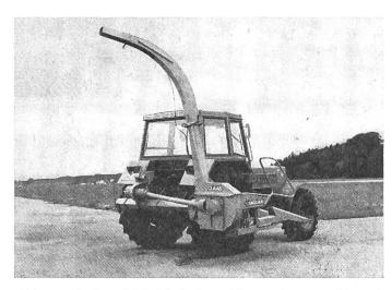
Abb. 1: Anbau-Maishäcksler Claas Jaguar 30 mit senkrecht stehenden Einzugswalzen und senkrechter Messertrommel.
