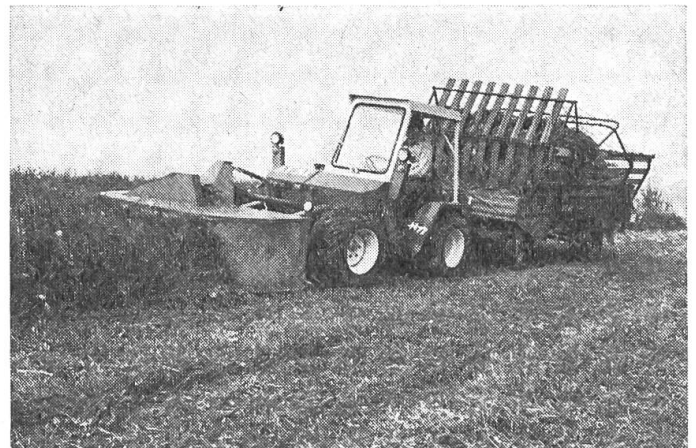
Abb. 5: Aebi-Terratrac TT 77 beim Eingrasen mit PZ-Rotormäher und Fella-Ladewagen.
