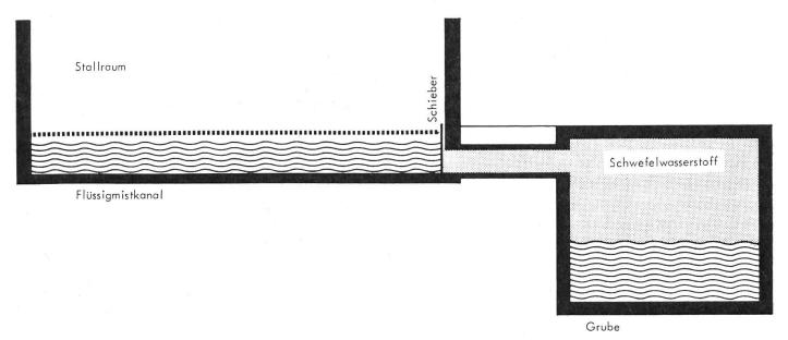
Abb. 1: Freigesetzter Schwefelwasserstoff (H2S) nach Umrühren und Entnahme des Grubeninhaltes.
