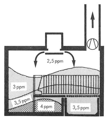
Abb. 4: Gasprofile für Ammoniak (NH₃) in einem Ferkelstall mit Flatdecks, Stallufttemperatur 20° C.
