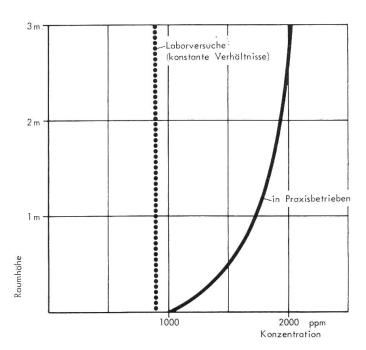
Abb. 6: CO<sub>2</sub>-Gehalt der Stalluft in verschiedenen Raumhöhen (schwedische Untersuchungen aus dem Jahre 1967).
