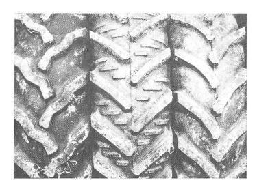
Abb. 7: Hohe, scharfe Stollen und grosse Oeffnungen in der Profilmitte (mittlerer Reifen) bringen in schwierigen, ebenen Ackerböden sehr gute Resultate. Bei Schichtlinienfahrt sind hingegen Reifen mit grossflächigen und weniger hohen Stollen im Vorteil (links und rechts aussen).
