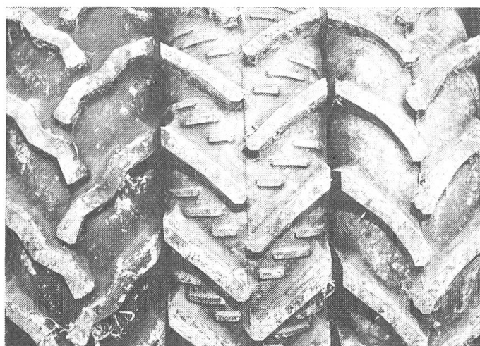
Abb. 7: Hohe, scharfe Stollen und grosse Oeffnungen in der Profilmitte (mittlerer Reifen) bringen in schwierigen, ebenen Ackerböden sehr gute Resultate. Bei Schichtlinienfahrt sind hingegen Reifen mit grossflächigen und weniger hohen Stollen im Vorteil (links und rechts aussen).
