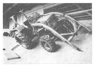
Abb. 3: Versuchstraktor auf der Kippbühne. Montierte Bereifung: Continental Farmer (Reifen Nr. 0), zu drei Viertel abgefahrener Diagonalreifen.
