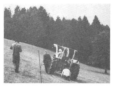
Abb. 2: Abtriftmessung: Der Markierpfeil vorne links am Traktor wurde genau einer gespannten Leine entlang gefahren. Die Abtrift der Hinterräder, relativ zu den Fronträdern, war am Massstab am Traktorheck direkt ablesbar. Gleichzeitig wurde die Geländeneigung bestimmt.
