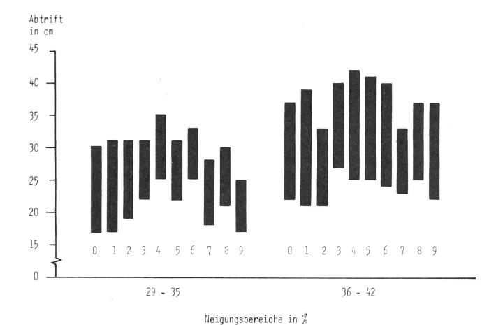
Abb. 5: Abtriftbereiche der Versuchsreifen Nr. 0 bis Nr. 9, bei Hangneigungen von 29 bis 42%.
