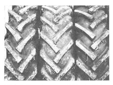
Abb. 6: Profile mit eng ausgebildeter Laufflächenmitte, durch weites Ueberlappen der langen und kräftigen Stollen. Der Reifen Nr. 3 (rechts aussen) besitzt höhere und etwas weiter gewinkelte Stollen als der Reifen Nr. 2 (Mitte). Reifen Nr. 3 wird dadurch bereits anfälliger für Abtrift als Reifen Nr. 2.
