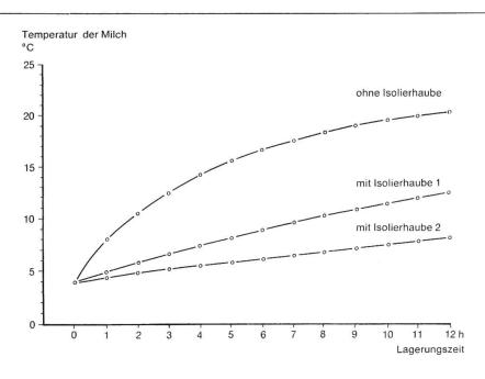
Abb. 3: Erwärmung der Mlich in der Milchkanne nach 12 Stunden Lagerung (Isolierhaube 1 ohne Bodendeckel, Isolierhaube 2 mit Bodendeckel), (nach E. Flückiger und F. Walser).
