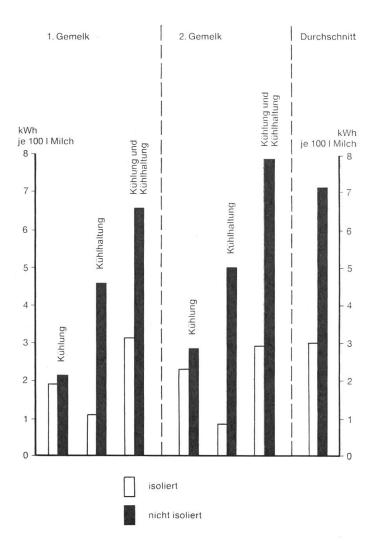
Abb. 2: Energieverbrauch für Kühlung und Kühlhaltung der Milch in isolierten und nicht isolierten Eiswasserbecken (nach E. Flückiger und F. Walser).
