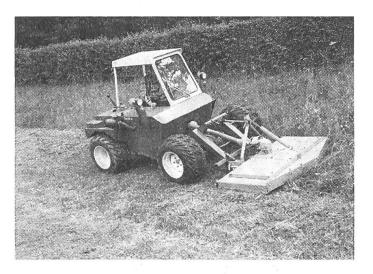
Abb. 2: Aebi Terratrac TT 77 mit seitlich hydraulisch verstellbarem Sichelmäher.
