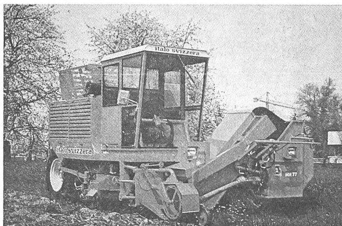
Abb. 9: Einreihiger selbstfahrender Bunkerköpfroder mit Allradantrieb und Langblatt-Querschwadeablage. Alle Aggregate werden durch Hydromotoren angetrieben.
