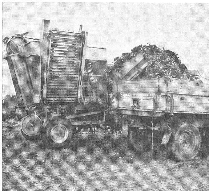
Abb. 8: Einreihiger Bunkerköpfroder mit Blatthäcksler und -bunker. Geringere Beeinträchtigung der Bodenstruktur, hochwertige Futterqualität des Rübenblattes und keine Verzögerung für nachfolgende Bestellarbeiten sind die wesentlichen Vorzüge dieses Verfahrens. Diese Maschinen erfordern aber entsprechend schwere Traktoren ab zirka 60 kW (80 PS).
