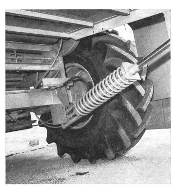
Dieses Bild zeigt den Druckzylinder für die Schneidtisch-Höhenführung.
