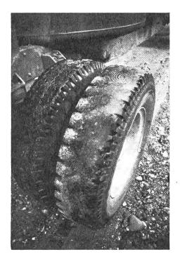
Abb. 4: Regelmässige Kontrolle des Luftdrucks mit einem zuverlässigen Prüfgerät und Einhaltung der zuverlässigen Radlasten gehören zu einer fachgerechten Reifenpflege. Vorteilhaft ist, wenn die vorgeschriebenen Werte am Fahrzeug selbst vermerkt sind und auch noch nach Jahren lesbar bleiben.
