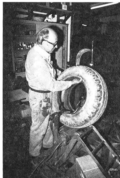
Abb. 3: Neugummierte Reifen sind neuen praktisch ebenbürtig, ermöglichen aber eine erhebliche Kosteneinsparung (Neugummierte Front-Triebreifen).
