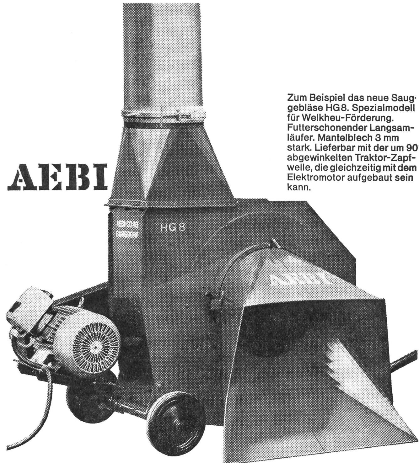
Zum Beispiel das neue Saug-gebläse HG8. Spezialmodell für Welkheu-Förderung. Futterschonender Langsam-läufer. Mantelblech 3 mm stark. Lieferbar mit der um 90° abgewinkelten Traktor-Zapf-welle, die gleichzeitig mit dem Elektromotor aufgebaut sein kann.
