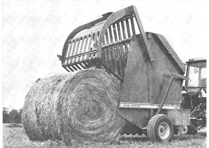
Abb. 1: Die Rundballenpresse formt frontladergerechte Ballen.
