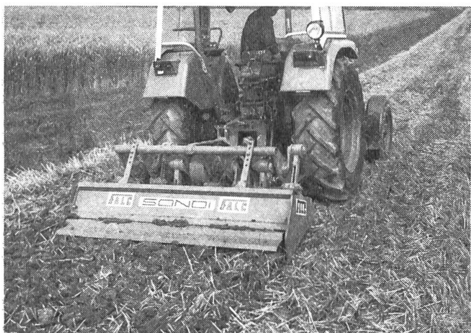
Abb. 2 und 3: Bei den Spatenmaschinen «Celli und «FALC» werden die Pendelspaten durch eine Kurbelwelle in Betrieb gesetzt. Die Schutzvorrichtungen sind auch hier ungenügend.
