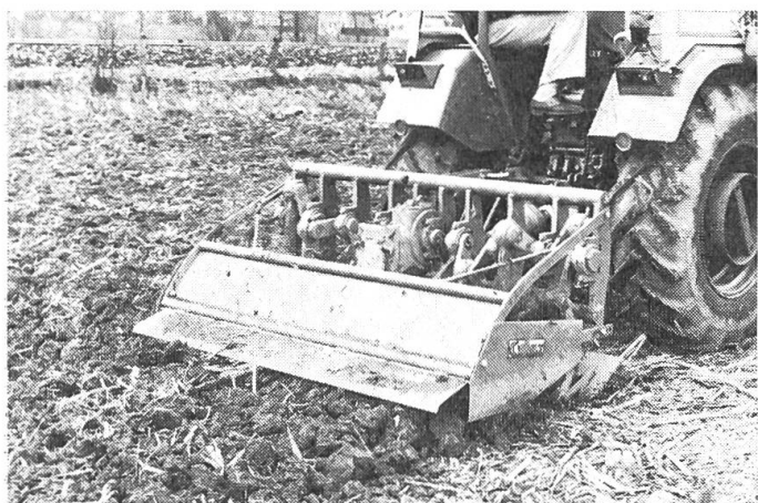
Abb. 2 und 3: Bei den Spatenmaschinen «Celli und «FALC» werden die Pendelspaten durch eine Kurbelwelle in Betrieb gesetzt. Die Schutzvorrichtungen sind auch hier ungenügend.
