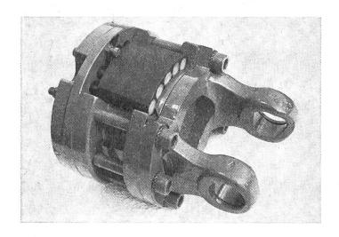
Zur Absicherung von zapfwellenangetriebenen Maschinen gibt es die Scherstiftkupplung. Die Vorteile: a) Bei Ueberlastung der Maschine eine absolute Unterbrechung der Zapfwellenkräfte, somit keinen Verschleiss der Getriebeteile.
