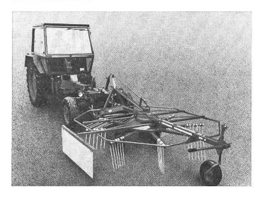
Speziell für den Anbau an die Fronthydraulik von Systemschleppern wie Fendt, Intrac, Kramer, MB-trac, Unimog und an Traktoren mit Fronthydraulik und Frontzapfwelle wurde der Schwadkreisel 301 F entwickelt. Für Fendt-Geräteträger ohne Hubwerk wurde ein einfaches Ersatz-Hubwerk entwickelt, welches mit Schnellverschlüssen an den beiden Hubzylindern der Kippritsche angebaut wird.
