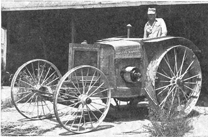
Abb. 4: Erster Massey-Ferguson-Traktor. Hergestellt vor 60 Jahren, Modell Massey-Harris Nr. 1. Er wurde angetrieben durch einen quergestellten 4-Zylinder-Benzinmotor, welcher an der Zapfwelle 12 PS und an der Riemenscheibe 25 PS leistete.
