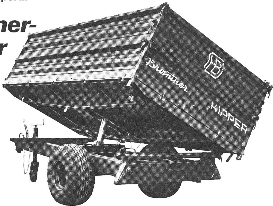
**Stahlboden** aus einem Stück gepresst, 5 mm stark (also nicht angeschweisst und nur 4 mm stark)
