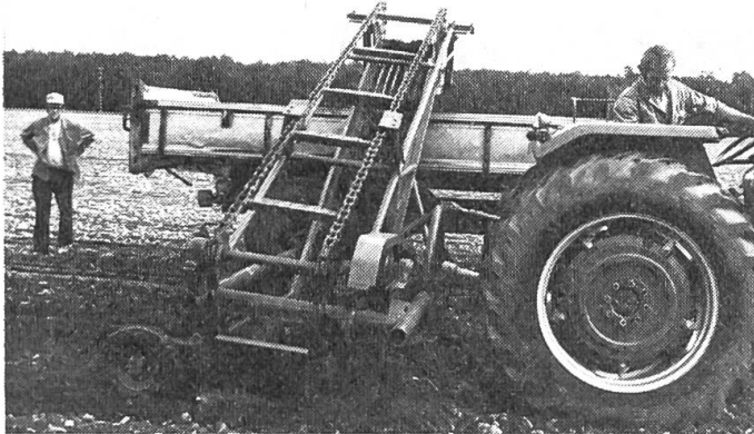
Abb. 5: Der Steinsammler Kvernelands mit Siebrost und Förderkette; seine Arbeitstiefe ist infolge geringer Siebleistung auf 5–10 cm begrenzt.
