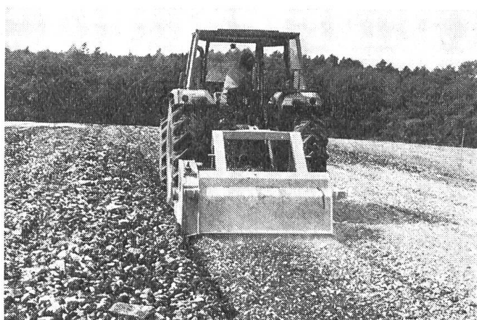
Abb. 12: Das Zerkleinern der Kalksteine in Jura-Lehmböden mit dem Steinbrecher (Nicolas) stellt gegenüber dem Steinsammler ein vielversprechendes Verfahren dar; bei diesem Verfahren wird das Volumen der Ackerkrume nicht verändert.
