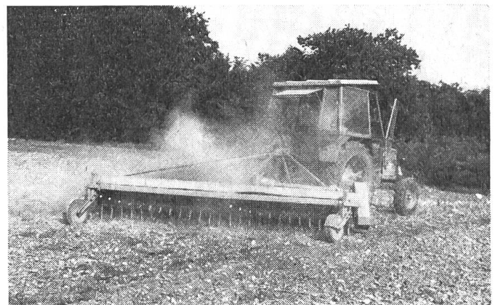
Abb. 10: Ein Schwadreden kann bei geringerem Steinbesatz die Wirksamkeit der Entsteinungsmaschinen erhöhen. Die Steine werden aus einer Bodenschicht von 5–10 cm ausgekämmt und in eine Schwade abgelegt.
