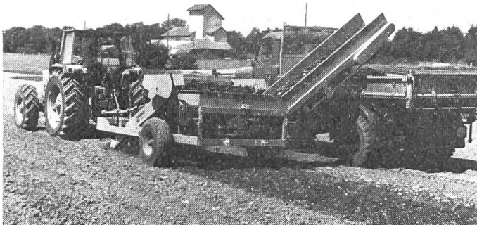
Abb. 6: Der Steinsammler MCA mit Siebketten und Verladeband kann bis 15 cm Arbeitstiefe eingesetzt werden. Die Erde wird hauptsächlich auf den Siebketten und teilweise auf dem Verladeband abgesiebt.
