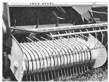
Die Pick-up ist breit. Der Abstand der Zinken beträgt nur 63 mm. Sie ist 25 cm seitlich vom Presskanal versetzt angeordnet. Dadurch wird vermieden, dass die Traktorreifen über das Schwad laufen. – Deshalb nehmen John Deere-Pressen so sauber auf.
