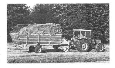
hat zum futterschonenden Laden das kraftsparende Aufnahmeaggregat mit geschobener Pickup und Kettenförderer. Mit einer Silierschnitt-Einrichtung von insgesamt 23 Messern kann Futter auf die «Ideallänge» von 60 mm geschnitten werden, aber auch — bei Verwendung von z.B. nur 12 Messern — auf 120 mm. Das Fassungsvermögen beträgt mit Grünfutter-Aufbau 16 m³, mit Dürrfutter-Anbau 32 m³. Entladen wird nach hinten über den breiten Kratzboden mit Schnellentlade-Einrichtung. Der K 30 hat wie der
