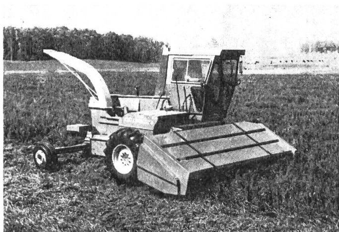
Abb. 4: Futtererntemaschine New-Holland. Das Mähwerk dieser Maschine kann durch eine Pic-Up-Trommel oder ein 3-reihiges Maisgebiss ersetzt werden.
