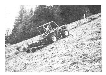
Abb. 9: Der mit einer sogenannten Terrabereifung (Niederdruckreifen) ausgerüstete Knickschlepper zeigte bei einer Vorführung eine gute Hangtauglichkeit bei Fallinienfahrt.
