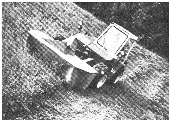
Abb.7: Eine sehr grosse Hangsicherheit wird auch mit dieser Arbeitsmaschine erreicht, wobei ausgesprochene Steilflächen besser in Falllinienfahrt zu bearbeiten sind.
