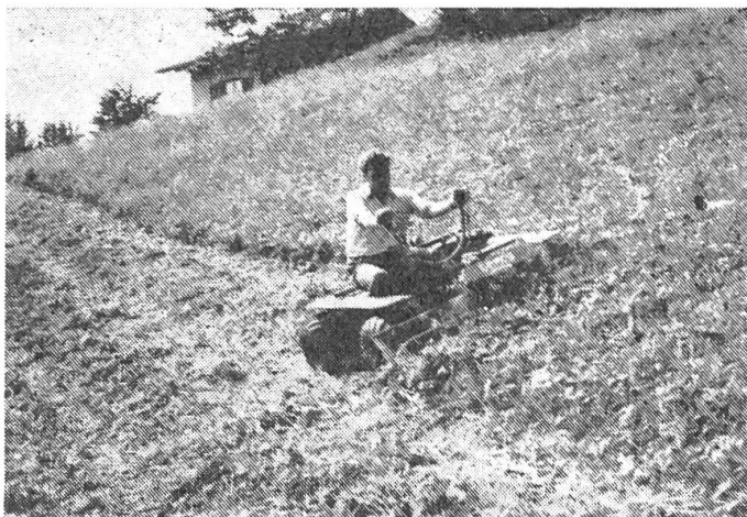
Abb.6: Die tiefe Schwerpunktlage und die gut haftenden Niederdruckreifen bewirken eine ausgezeichnete Hangtauglichkeit.
