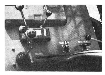
Abb. 10: Bei diesem Transporter ist für jede Getriebefunktion ein eigener, vom Fahrersitz aus gut erreichbarer, Schalthebel vorgesehen. Wenn noch dazu eine sehr gute Gangabstufung mit 8 Vorwärtsund 8 Rückwärtsgängen vorhanden ist, kann man durchaus von einem Optimalzustand sprechen.
