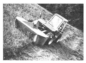
Abb. 7: Eine sehr grosse Hangsicherheit wird auch mit dieser Arbeitsmaschine erreicht, wobei ausgesprochene Steilflächen besser in Fallinienfahrt zu bearbeiten sind.
