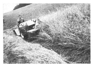
Abb. 8: Dieses 52 PS starke hangtaugliche Fahrzeug hat durch die gute Bodenfreiheit und der Möglichkeit AS-Reifen zu verwenden auch sehr gute Zugeigenschaften.
