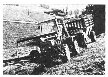
Abb. 3: Ein Zweiachsmäher soll hangtauglich sein, damit der Motormäher ersetzt werden kann. Als einzige Zugkraft kommt er nur in wenigen Fällen in Frage, da seine Hangtauglichkeit mit Ladewagen oder Mistzetter nicht höher liegt als beim Allradtraktor.
