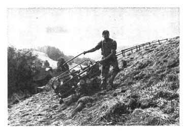
Abb. 2: Der Bandrechen lässt sich heute mit wenig Aufwand an den Motormäher anbauen. Diese Lösung ist vor allem in Bergbetrieben mit Kreiselzettwender praktisch und wirtschaftlich.
