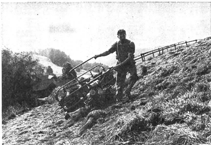
Abb. 2: Der Bandrechen lässt sich heute mit wenig Aufwand an den Motormäher anbauen. Diese Lösung ist vor allem in Bergbetrieben mit Kreiselzettwender praktisch und wirtschaftlich.
