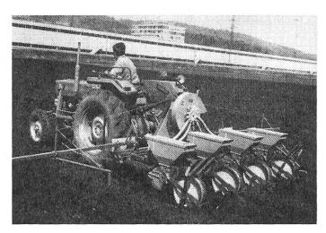
Abb. 7: Die im Maisbau angestrebten Anforderungen wie gleichmässige Einzelkornablage und Sätiefe werden mit den pneumatischen Einzelkornsämaschinen weitgehend erfüllt.
