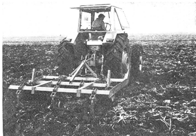
Abb. 3: Mit einem Meisselgrubber lassen sich die bestehenden Bodenverdichtungen beseitigen.
