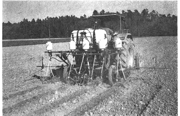
Abb. 9: Mais-Einzelkornsäat mit gleichzeitiger Herbizid-Bandspritzung und Ausbringen von Insektizid-Granulaten.
