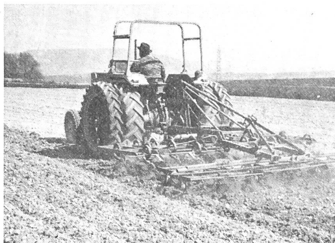
Abb. 4 und 5: Für die Saatbettvorbereitung haben sich intensivarbeitende Gerätekombinationen bzw. Kreiseleggen, besonders gut bewährt. Die Ausrüstung des Traktors mit Doppelbereifung trägt zur Verminderung der Bodendruckschäden bei.
