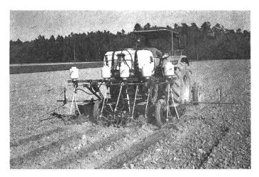
Abb. 9: Mais-Einzelkornsaat mit gleichzeitiger Herbizid-Bandspritzung und Ausbringen von Insektizid-Granulaten.
