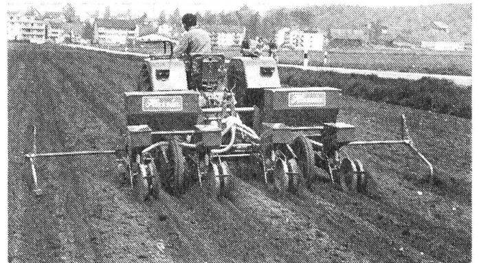
Abb. 7: Die im Maisbau angestrebten Anforderungen wie gleichmässige Einzelkornablage und Sättiefe werden mit den pneumatischen Einzelkornsämaschinen weitgehend erfüllt.
