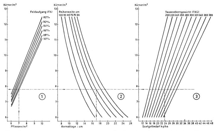
Abb. 6: Nomogramm zur Bestimmung der Saatmenge des Kornabstandes und Saatgutbedarfes im Maisbau (Beispiel – gestrichelte Linie):
