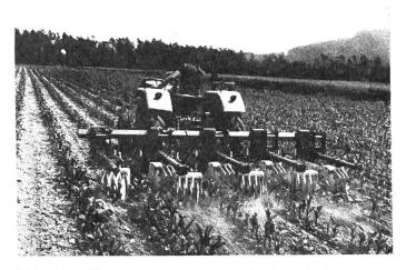
Abb. 10: Für die mechanische Unkrautbekämpfung im Mais eignen sich Geräte mit Hacksternen «System Lilliston» und auch solche mit gezahnten Scheiben besonders gut.
