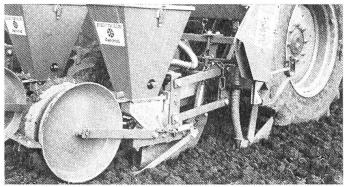
Abb. 8: Die Unterfussdüngung kann mit einem Aufbau-Reihenstreuer vorgenommen werden. Der Dünger wird 5 cm neben der Saatreihe und in einer Tiefe von 10 bis 12 cm abgelegt, unten Detailaufnahme.
