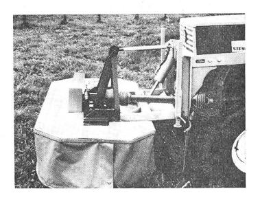
zahl von 1000 U/min ausgelegt ist und über die vorhandene Zapfwellenkupplung bedient werden kann. Bei Traktoren, bei denen direkt vorn am Motor abgetrieben werden muss, sind zusätzlich eine Kupplung und ein Getriebe erforderlich. Bei den Steyr-Traktoren ist die vordere Zapfwelle gut für 15 kW (20 PS); damit können sogar Kreiselmähwerke angetrieben werden.
