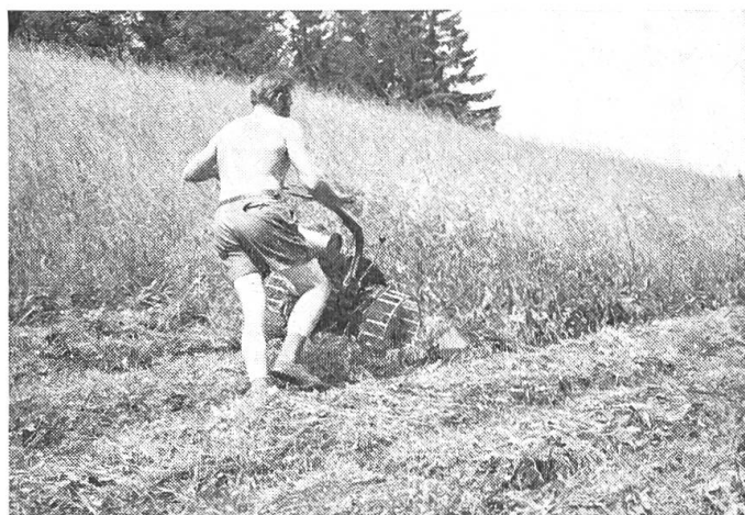
Abb. 5: Giterräder oder Doppelbereifung erhöhen die Sicherheit am Hang und erleichtern die Führung bei Schichtenlinienfahrt.
