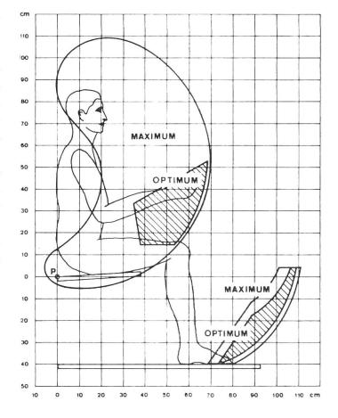
Abb. 1: Häufig bediente Hebel, Schalter und Pedale sollten so angeordnet sein, dass sie rasch und mühelos (ohne Bücken oder Rutschen) erreicht werden können (Schema nach Zander. P = Bezugspunkt des Sitzes).
