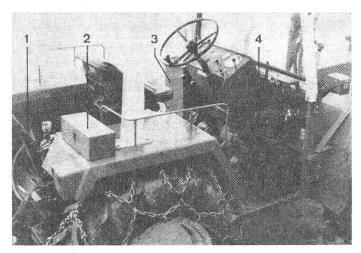
Abb. 6: Gut zugängliche Stellen wie Stecknagel (1), Werkzeugkasten (2), Treibstofftank (3), Batterie (4), erleichtern täglich die Arbeit und ersparen manches Kraftwort...
