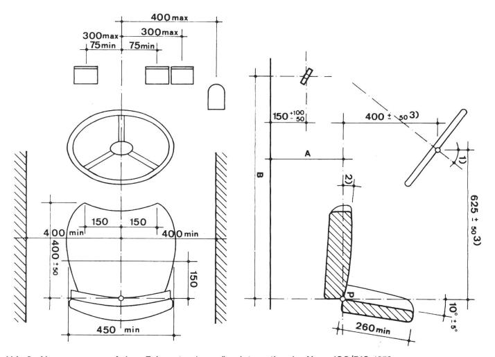
Abb. 2: Abmessungen auf dem Fahrerstand gemäss internationaler Norm ISO/DIS 4253.
