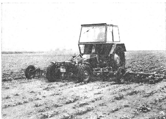
Abb. 4: Fendt-Geräteträger F 275 GT (51 kW/70 PS) mit 12-reihiger Rübenhacke (6 m Arbeitsbreite) und einer Flächenleistung bis zu 3 ha/h. Zentraldrehgelenk und zusätzliche Führungsräder garantieren eine hervorragende Anpassung an Bodenunebenheiten.
