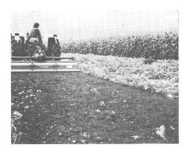
die Arbeitsbreiten 1,80 m und 2,05 m mit 42 bzw. 48 Messern bekommen. Serienmässig ist das 3-Stufen-Schaltgetriebe. Die Messerwelle dreht bei Verwendung der 540er-Zapfwelle 150, 190 oder 230 min/1. Bei Zahnradwechsel kann man auch die 1000er-Zapfwelle verwenden. Alle Fräsen sind mit seitlichem Antrieb ausgerüstet, es entsteht also kein unbearbeiteter Mittelsteifen. SILENT AG, 8108 Dällikon
