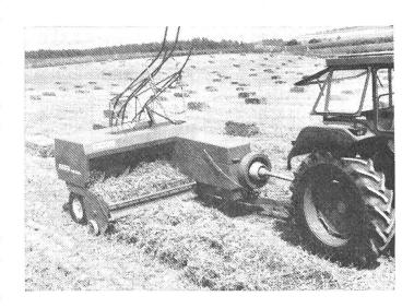
Die Länge der Pressballen ist stufenlos von 0,3 bis 1,3 m einstellbar. Das Knüpfaggregat arbeitet mit 90 Kolbenstössen in der Minute. Für den Knüpfvorgang kann Sisalgarn (150–200 m Lauflänge je kg) und Kunststoffgarn (320–400 m Lauflänge je kg) verwendet werden. Der witterungsgeschützte Garnkasten kann bis zu 10 Bindegarnrollen aufnehmen. Dies entspricht einem Tagesbedarf.
