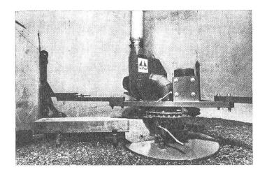
ist auch das Wechseln von einem Silo zum andern. Ohne aufwendige Zerlegarbeit bringt man die Fräse durch einfaches Zusammenklappen auf eine minimale Grösse, die ein Aufziehen und Einfahren durch die Dachluke erlaubt.
