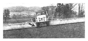
Abb. 2: Beim Spritzen am Hang in der Schichtlinie verflachen sich die Traktorreifen infolge Schwerpunktverschiebung. Dank der Hangausgleich-Vorrichtung kann das Spritzgestänge parallel zur Bodenfläche eingestellt werden (Birchmeier).
