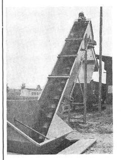
Die in den Abladetrichter gekippten Rüben oder Kartoffeln werden schnell und schonend durch eine Förderschnecke in den Eisenbahnwagen gefördert. Wirksame Enterdung und Entkrautung. Erd- und Steinabscheider.
