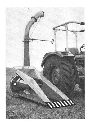
Abb. 3: Anbau-Maishäcksler mit Signalisationsblech, das zugleich als Schutz dient.
