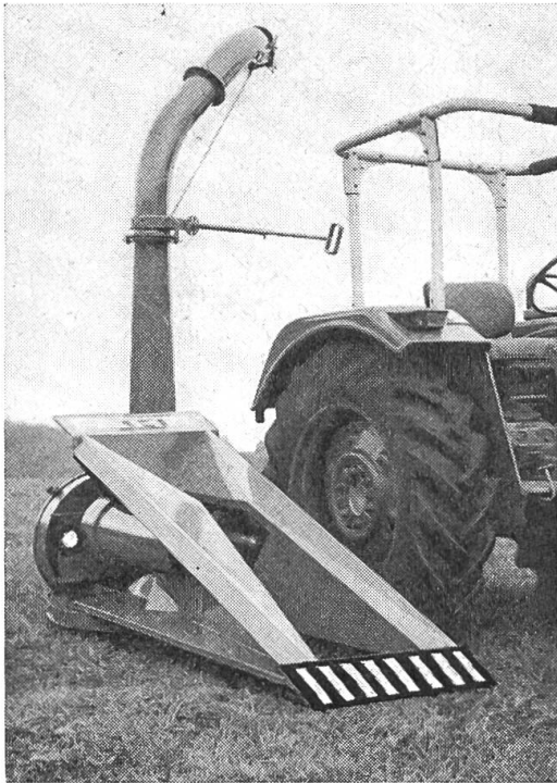
Abb. 3: Anbau-Maishäcksler mit Signalisationsblech, das zugleich als Schutz dient.
