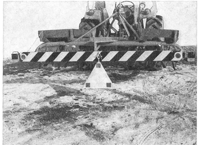
Abb. 1d: Spatenegge mit Signalisations- und Schutzbrett.
