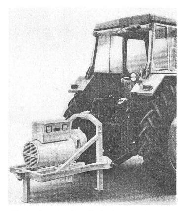
Abb. 4: Transportabler Zapfwellengenerator angebaut am Dreipunktgestänge des Traktors. Leistung: 25 kVA.
