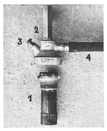
Abb. 8: Injektorvakuumpumpe - Kirpy - für Anbau ans Auspuffrohr des Traktors.
