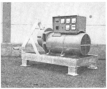
Abb. 5: Zapfwellengenerator für Dreipunktanbau. Leistung: 25 kVA.
