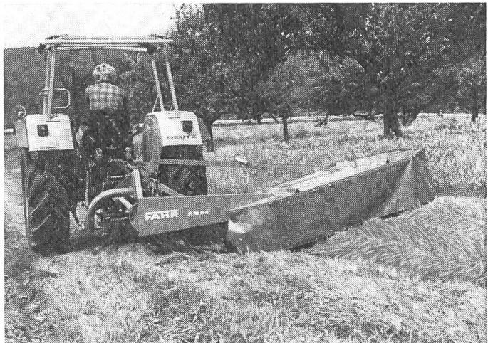
Der Kreiselmäher bringt seine volle Leistung auch beim Ausmähen von Böschungen und Gräben. Neigung  $\pm 20^\circ$  bewältigt er spielend. Selbst ein übersehenes Hindernis kann dem Kreiselmäher wenig anhaben. Eine Auffahrtsicherung erlaubt das Ausklinken und Zurückschwenken der Maschine.
