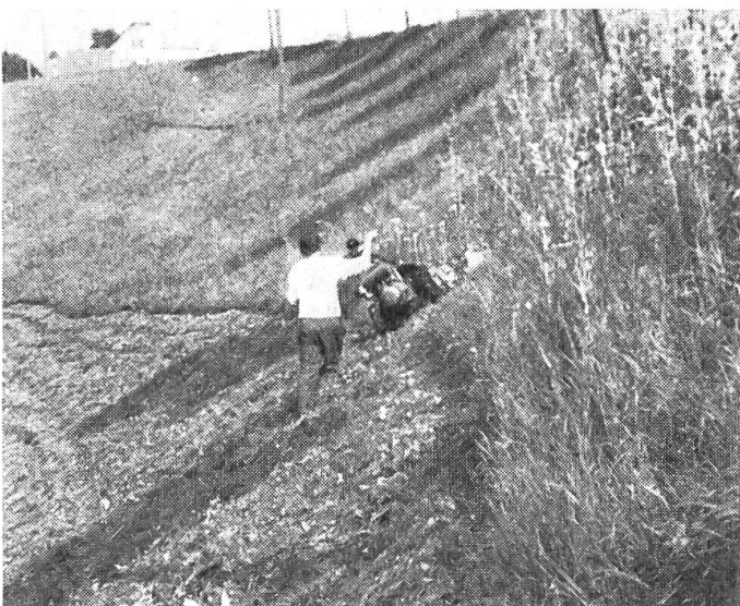
Abb. 1: Der Bergmäher mit zusätzlichen Gitter- oder Stollenrädern ist heute die hangtauglichste Maschine.
