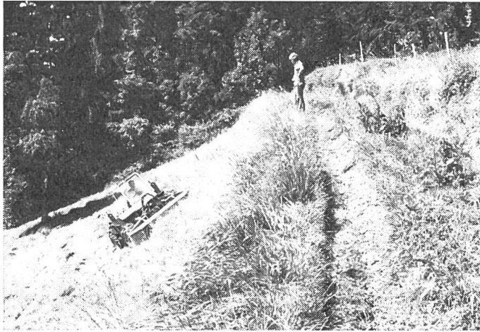
Abb. 7: Ein hangtauglicher Zweiachsmäher erreicht in Hanglagen eine sehr gute Arbeitsleistung und lässt sich bis zu 65% Neigung sicher einsetzen. Betriebs-sichere Maschinen mit einem wartungsarmen Kreisel-mähwerk bieten auch gute Voraussetzungen für den überbetrieblichen Einsatz.
