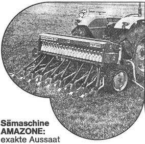
exakte Aussaat = Voraussetzung für eine gute Ernte, einfache Einstellung dank stufenlosem Getriebe.
