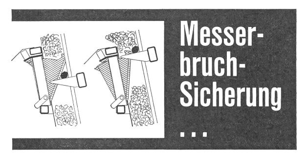
... ein Erfordernis für jeden modernen **Kurzschnitt-Ladewagen.**Fremdkörper, also Steine, Kreislerzinken etc. können weder an den Messern noch am Elevator Schaden anrichten. Die Messerbruch-Sicherung verhütet Arbeitsunterbrüche, teure Reparaturen und viel Ärger.
